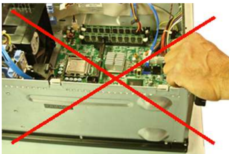
شکل ۹. اتصال زمین «فلز لخت» شاسی (غیرقابل قبول)
